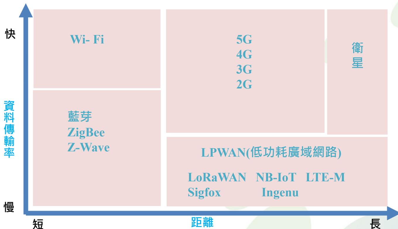
註：(1)資料傳輸率：以每秒傳輸 kilobits/megabits評估；(2)距離：最遠可傳輸距離
